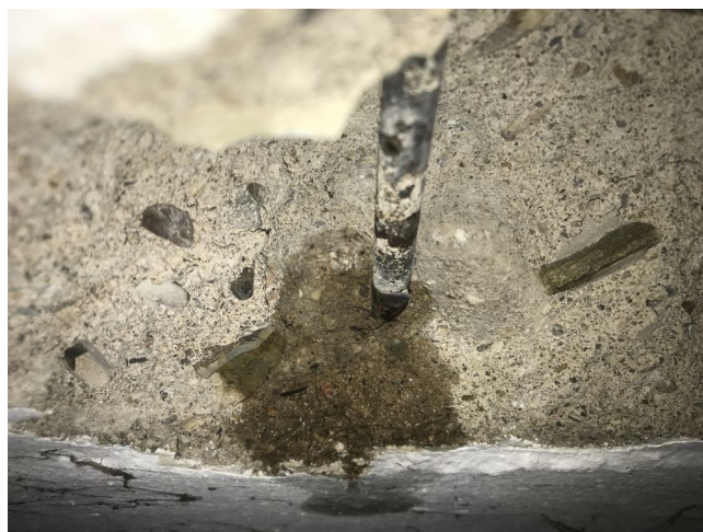
foto/83/ Zkarbonatovaný průřez betonu
